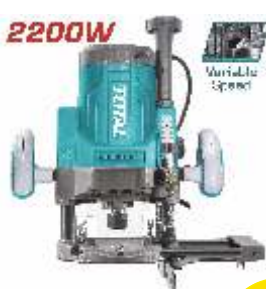
TR11226 Επαγγελματικό ηλεκτρικό ρούτερ 2200W / Στροφές 9000-23000rpm Υποδοχή 6/8/12mm, 1/4" - 1/2" Διαδρομή φρέζας 0-60mm
