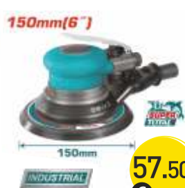
TAT91512 Επαγγελματικό έκκεντρο τριβείο αέρος Φ-150mm / 6.2bar 10500rpm Σωλήνα παροχής 3/8" Βάρος 1.65kg
