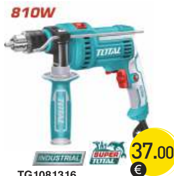
TG1081316 Επαγγελματικός δρέπανος κρουστικός ηλεκτρονικός 810W / Στροφές 0-2750rpm Κρούσεις 0-4800bpm Τσόκ 13mm
