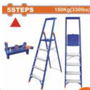
WLD1H05 Μεταλλική σκάλα αλουμινίου 5 σκαλοπάτια Διαστάσεις: 457 x 893 x 1568mm Αντοχή: 150 kg / Βάρος : 5 kg
